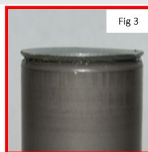
Fig 3: De borgring van de piston is gedeformeerd of verbogen. Dit illustreert dat de cylinder een te grote slag gemaakt heeft.
